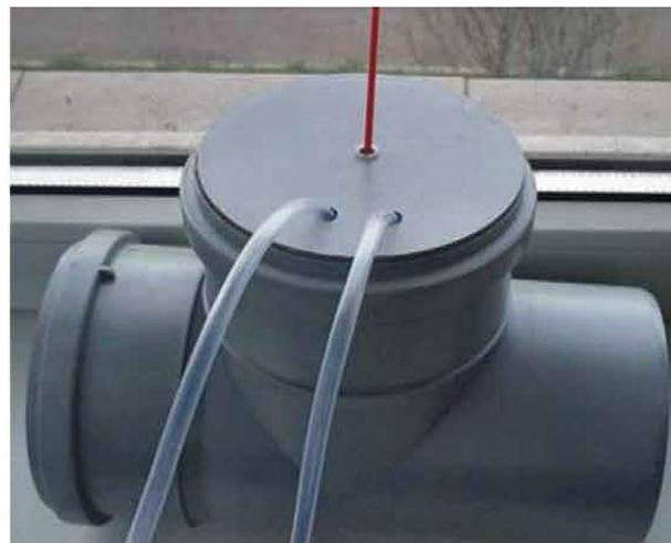
Рисунок IV.21 – Крепим трубочки, клеим колпачок, вставляем поплавок
