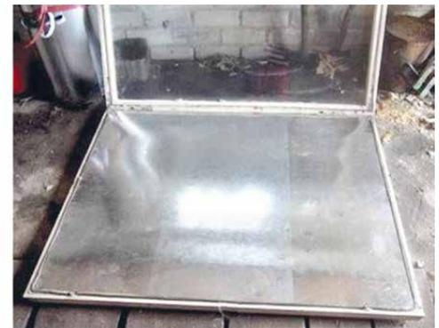
Рисунок I.50 – По периметру окна нужно приклеить уплотнительную резинку. Поверх утеплителя крепим лист оцинковки, который будет исполнять роль абсорбера
