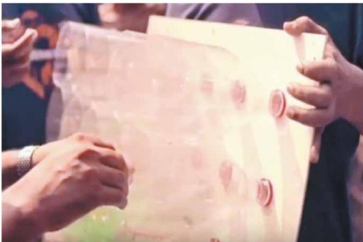
Рисунок 1.68 Вставить бутылки в картон. Закрутить крышки с обратной стороны
