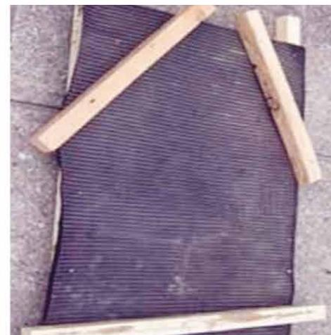
**Рисунок I.44** – Скотчем проклеиваем щели между каркасом и фольгой, чтобы предотвратить утечку горячего воздуха. С обратной стороны прибавляем дополнительные брусья для жесткости
