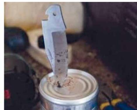
Рисунок III.26 – С помощью консервного ножа вырежьте отверстие по намеченным точкам
