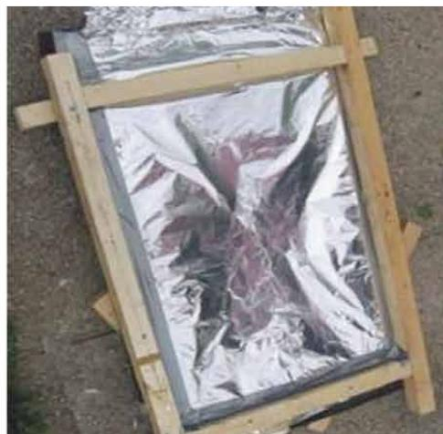
**Рисунок I.43** – Устанавливаем нижнюю рейку каркаса, расстилаем фольгу между резиновым ковриком и каркасом.
