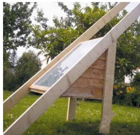
**Рисунок I.10 – Стекло крепим силиконом, а для надежности прижимаем держателями. В качестве ножек используем брусья**
