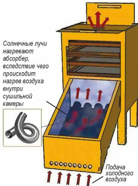
Рисунок I.29 – Технология процесса сушки [167]
