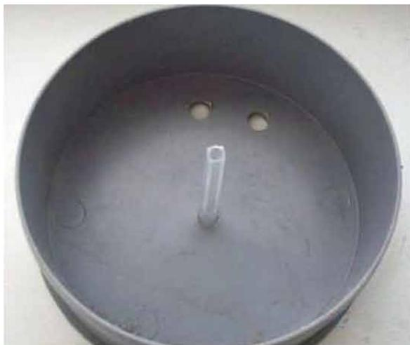
Рисунок IV.19 В заглушке труб просверлим три отверстия
