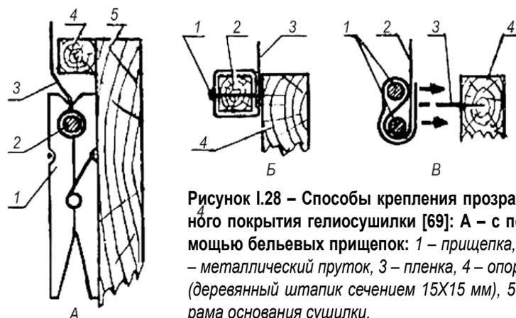
**Рисунок 1.28 – Способы крепления прозрачного покрытия гелиосушки [69]: А – с помощью бельевых прищепок: 1 – прищепка, 2 – металлический пруток, 3 – пленка, 4 – опора (деревянный штапик сечением 15X15 мм), 5 – рама основания сушилки.**
