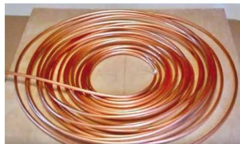
**Рисунок I.53 – Разложим трубку в один слой с небольшим отступом, чтобы прикинуть размеры солнечного коллектора**
