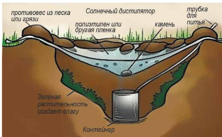
Рисунок III.20 – Устройство солнечного дистиллятора [153]
