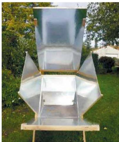
**Рисунок I.11 – Отражатели изготавливаем из зеркал, полированного алюминия или нержавеющей стали, приклеенных к фанере**
