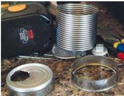
Рисунок III.27 – Срежьте донную и верхнюю часть банки, чтобы стенки жестяных колец остались ровными
