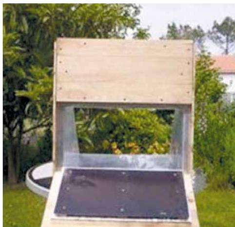
**Рисунок I.9 – Дверца, через которую контролируется приготовление еды**
