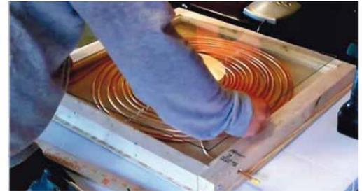
Рисунок 1.58 – Закрываем стеклом
