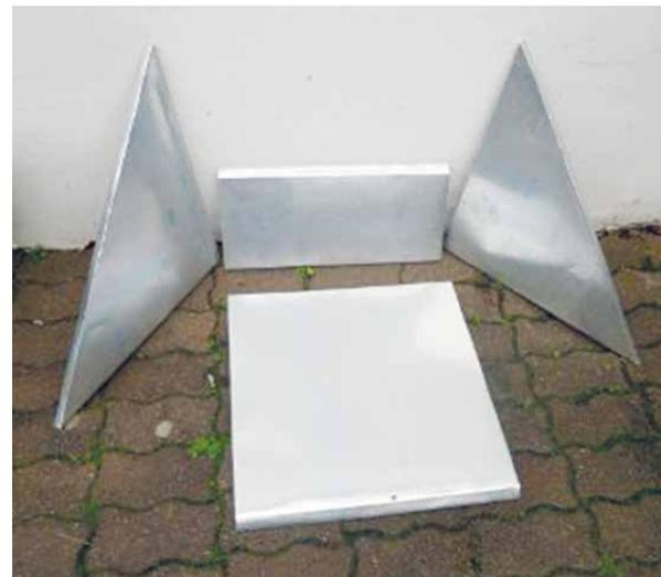
Рисунок I.7 – Внутреннюю поверхность солнечной печи оббиваем тонким слоем листового алюминия
