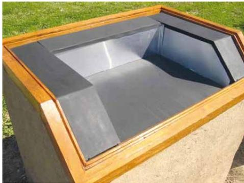
Рисунок I.25 – Чтобы придать печи привлекательный вид, варочную поверхность облагораживаем алюминиевыми листами, желательны окрашенными в черный цвет
