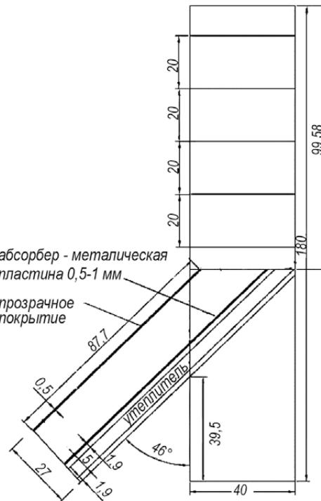
Рисунок I.30 – Рекомендуемые размеры для изготовления шкафа
