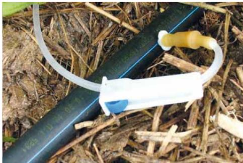
Рисунок II.17 – Отвод из капельницы [141]
