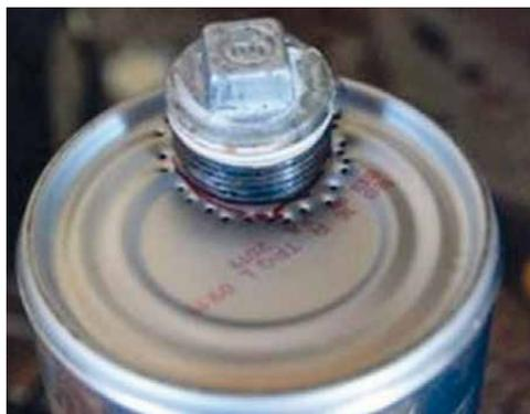
Рисунок III.25 – Приложите ко дну резьбу и по ее ободу с помощью гвоздя и молотка сделайте небольшие отверстия
