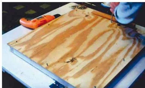
**Рисунок I.54 – Собираем короб и вкладываем в него фанеру со змеевиком**
