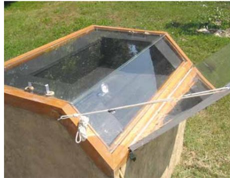
Рисунок I.26 – В качестве крышки используем стекло. Для увеличения температуры можно прикрепить отражатель (зеркало), направив солнечные лучи на варочную поверхность
