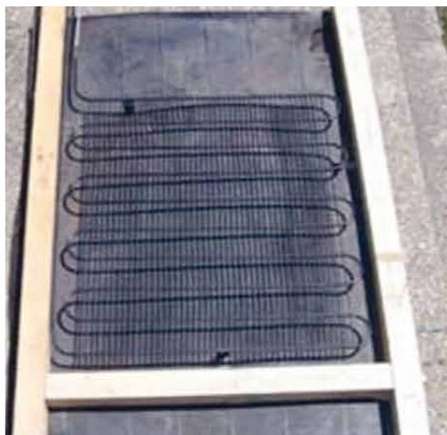
**Рисунок I.42** – Из реек сбиваем каркас, так, чтобы змеевик свободно помещался между реек. Примеряем змеевик и резиновый коврик к каркасу. Отмечаем место крепления нижней рейки каркаса и места пропилов для выхода трубок
