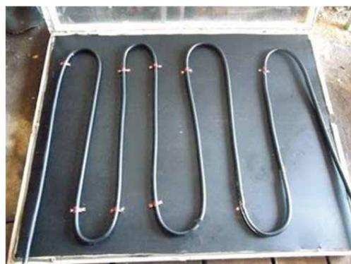
**Рисунок I.52 – Наиболее простой вариант теплообменника – «змейка» или, как по-другому ее называют «серпантин»**
